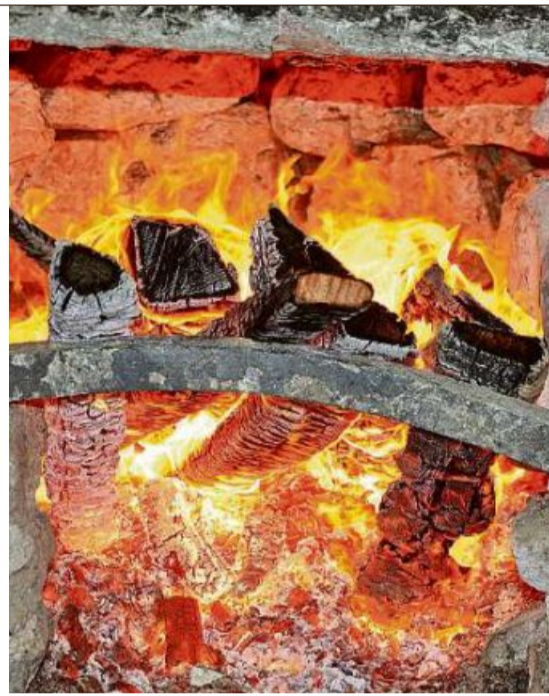
Faszinierende Transformation: Aus 14 Tonnen Dolomitsteinen werden sieben Tonnen Kalksteine.
